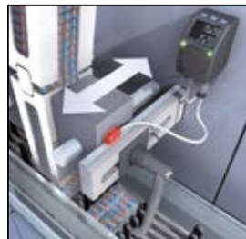
Réglage du format surveillé sur les coulisses grâce à des afficheurs de position électroniques.
