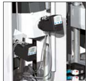
Automatisation complète de broches et de machines grâce à des servomoteurs.
