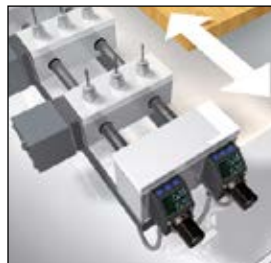
Cambio di formato monitorato su viti tramite indicatori di posizione elettronici.
