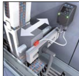
Cambio di formato monitorato su spostamenti di unità di spinta tramite indicatori di posizione elettronici.
